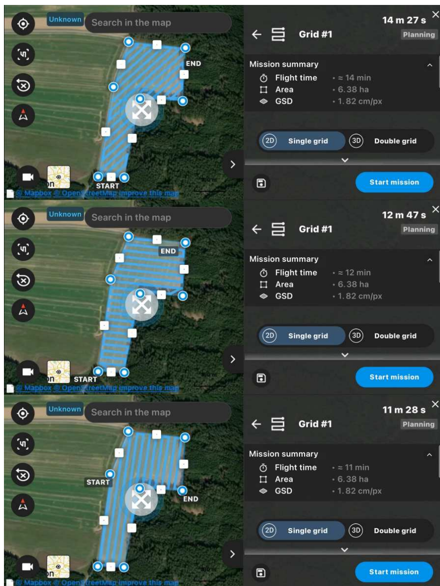
Obrázek 4: Vliv přeletů na provozní dobu mise
